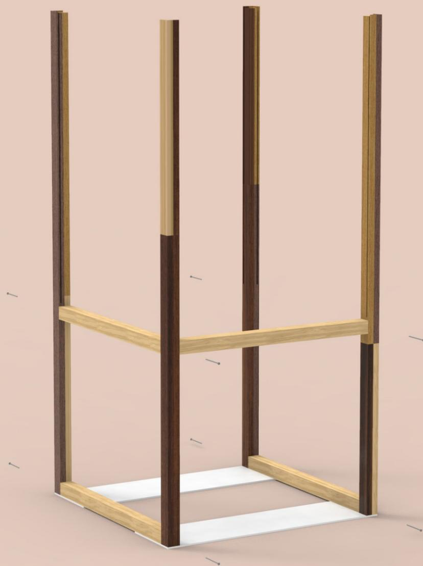
Cada montagem começa com o aparafusamento das barras de madeira. Evitámos o uso de cola nesta fase para permitir uma desmontagem rápida e fácil dos expositores.
